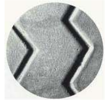
"Elephant skin" effect of ongelijke slijtage ("feathering"), veroorzaakt door te strak manoeuvreren waardoor de banden te zwaar zijn belast.
