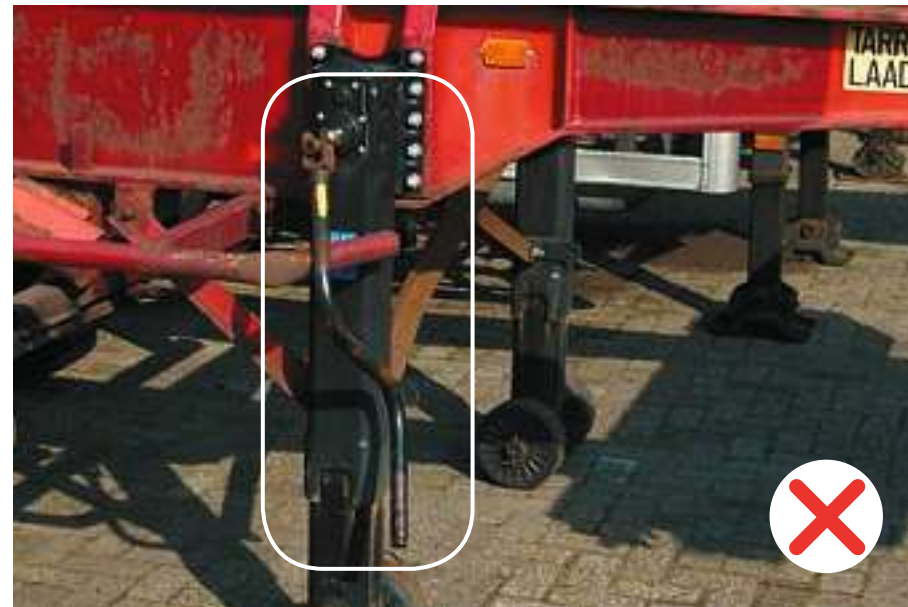
Steunpoot is vervangen maar er zijn geen faciliteiten om de slinger in de veilige stand te zetten. Indien er Jost-steunpoten zijn gemonteerd, is de garantie niet langer geldig indien deze gelakt zijn.
