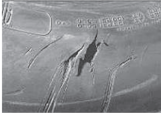
Schade aan band als gevolg van diepe doorboring van zijkant.
