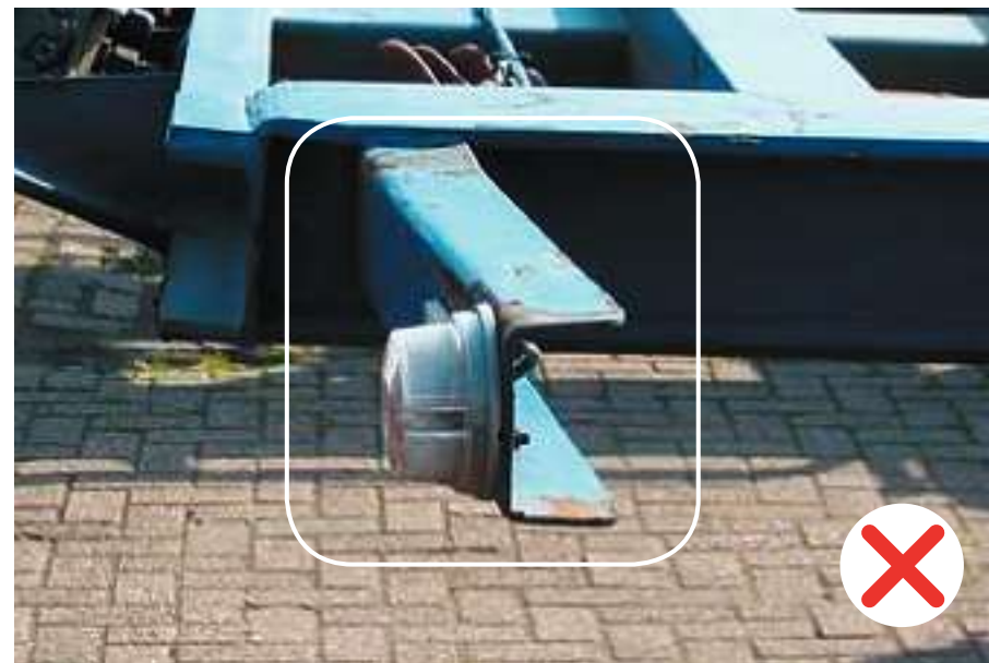
Verbogen lamparm: aan de klant worden geen kosten doorberekend indien het verschil niet meer dan 10% van de 90-graden hoek bedraagt. Aan de klant worden wel kosten in rekening gebracht indien de genoemde limiet wordt overschreden, alsook indien er een reparatie moet worden uitgevoerd naar aanleiding van een wettelijke inspectie (APK, etc.).
