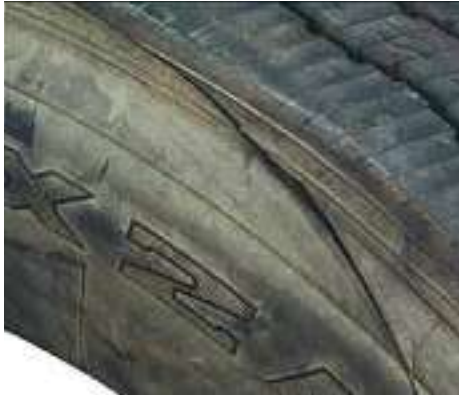
Diepe doorboring van band, schade aan bandschouder en zijkant.
