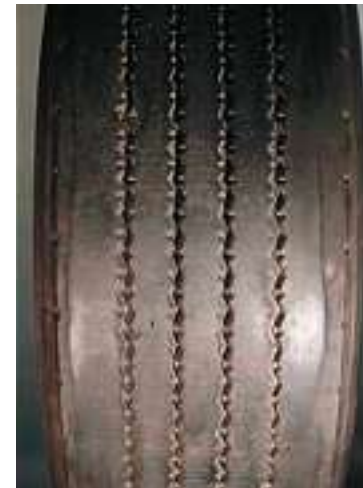
Versnelde slijtage van autobandschouder als gevolg van te lage bandenspanning.
