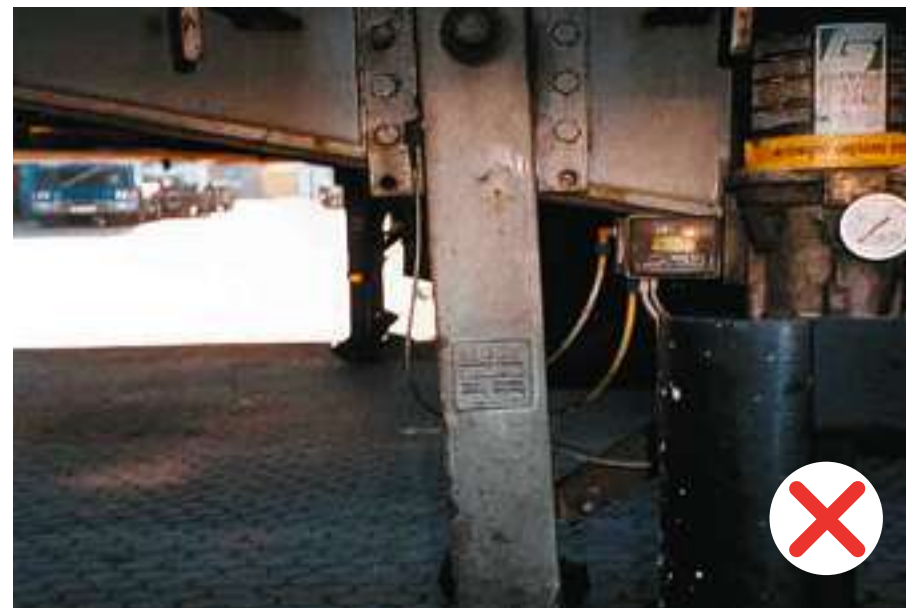
Verbogen steunpoot: aan de klant worden geen kosten doorberekend indien het verschil niet meer dan 10% van de 90-graden hoek bedraagt. Aan de klant worden wel kosten in rekening gebracht indien de genoemde limiet wordt overschreden of indien de steunpoot niet meer naar behoren functioneert.
