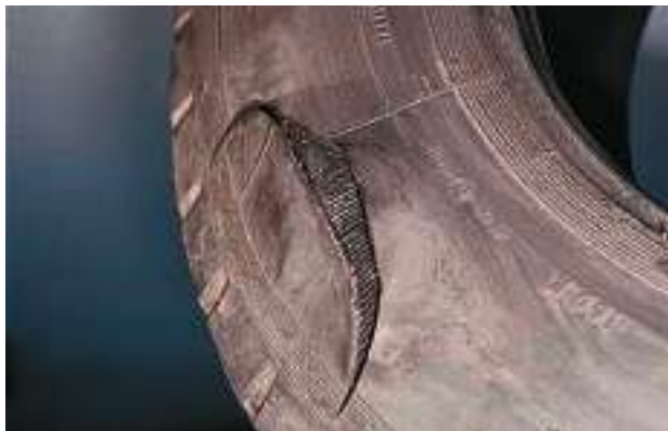
Zijvlak van band is geklapt als gevolg van doorboring van de binnenste koordlagen.
