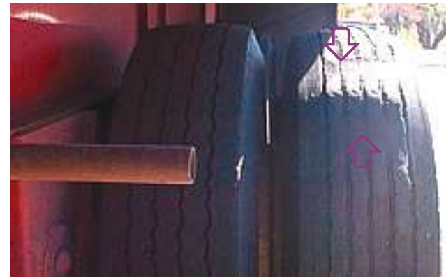
Dubbelluchtbanden met verschillende diameter of op andere wijze niet bij elkaar passend.
