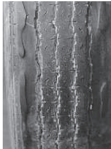
Ongelijkmatige slijtage als gevolg van wielophangingsprobleem.
