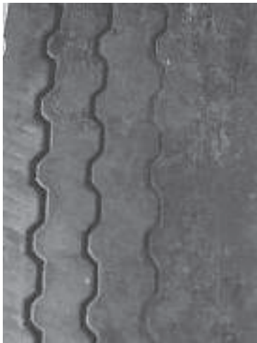
Ongelijkmatige slijtage als gevolg van verkeerde uitlijning of wielvlucht.
